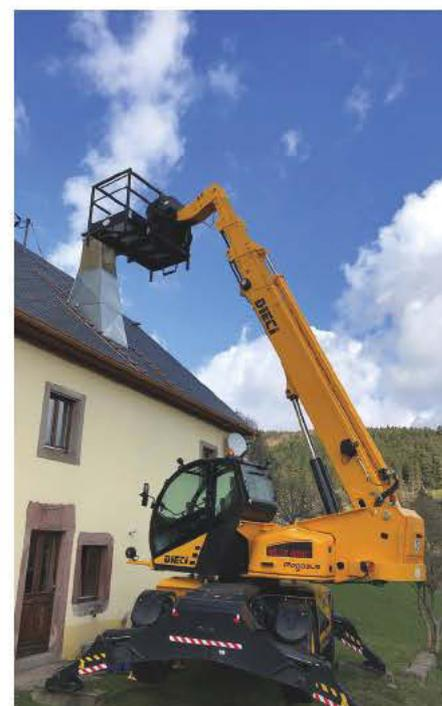
por el Pegasus gracias a sus 4 ruedas directrices, los 98 caballos del motor Kubota Stage IIIB/Tier4 y los 400° de rotación de la plataforma. Subir al tercer piso una claraboya de 300 kg, un palé de vigas de roble o de costosas y pesadas tejas de pizarra deja de ser un problema gracias a los 18 m de elevación y los 4000 kg de capacidad. Con los estabilizadores de nivelación automática, los suelos en pendiente ya no son un escollo insalvable. También es más fácil cambiar los canalones en el borde
