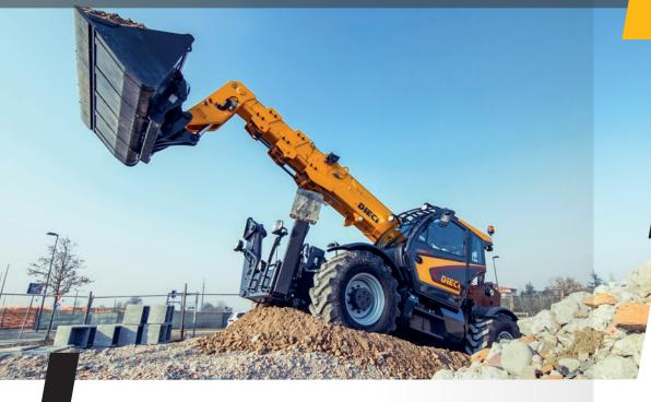
Icarus Dynamic, qui fait partie de la Nouvelle Gamme BTP, est la machine qui voit haut : le bras se déploie **jusqu'à 18 mètres** tout en conservant un **équilibre parfait** grâce aux stabilisateurs indépendants à commande proportionnelle.
