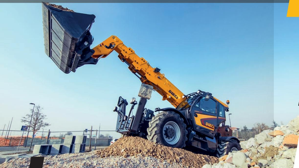
Dentro de la Nueva Gama Construcción, el Icarus Dynamic es ideal para las grandes alturas: se puede extender **hasta 18 metros**, sin renunciar a la **máxima estabilidad** gracias a los estabilizadores independientes con mando proporcional.
