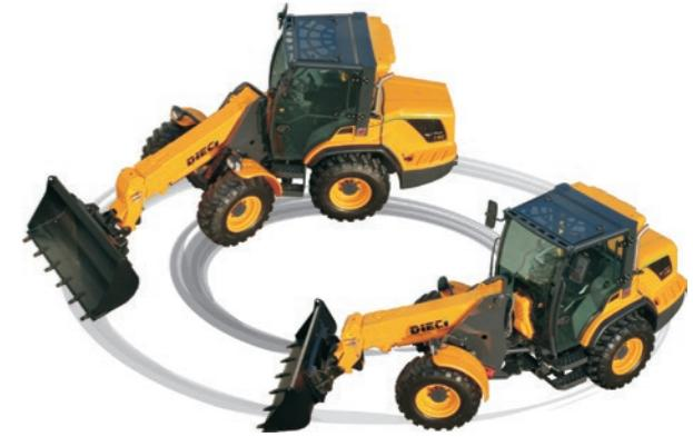
L'ingombro della macchina è sempre determinato dalle ruote anteriori o posteriori, garantendo all'operatore di non urtare con la parte posteriore in fase di manovra
