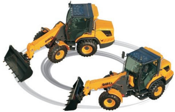
Le volume de la machine est toujours déterminé par les roues avant ou arrière, de sorte que l'opérateur ne puisse rien heurter avec la partie arrière en phase de manœuvre.
