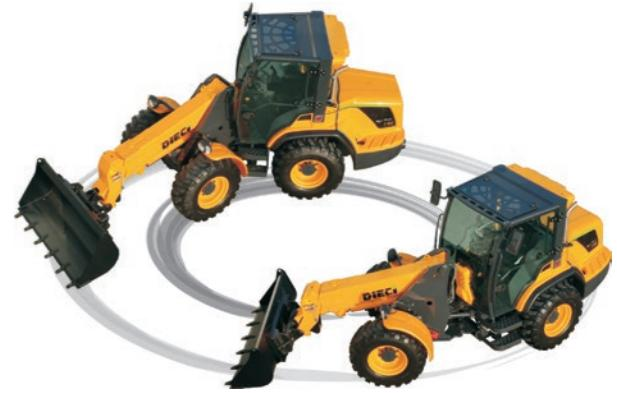
El gálibo de la máquina siempre está determinado por las ruedas delanteras o traseras para evitar el riesgo de impacto con la parte trasera al realizar maniobras.
