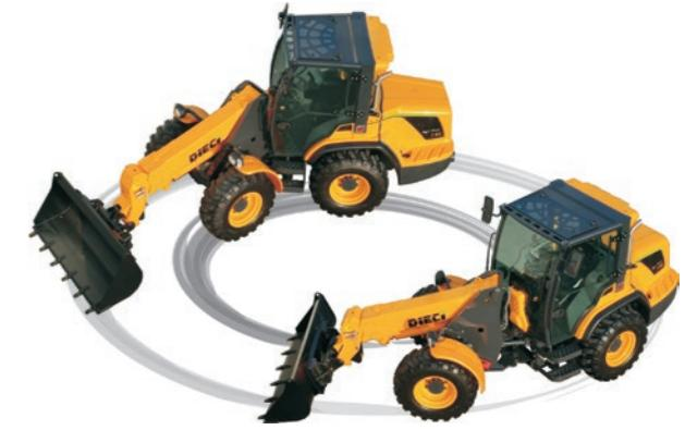
Die Außenmaße der Maschine werden stets durch die Vorder- oder Hinterräder bestimmt, weshalb keine Gefahr besteht, beim Manövrieren mit dem Maschinenheck anzustoßen.
