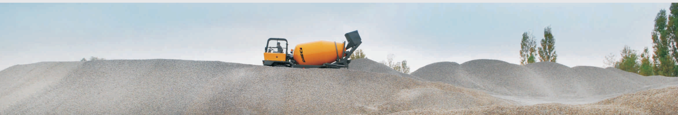
N 2400 49 hp capacità 2,4 m 3 resa 1,70 m 3
