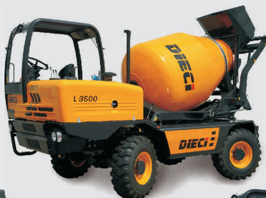
L 3500 112 hp capacità 3,5 m 3 resa 2,50 m 3
