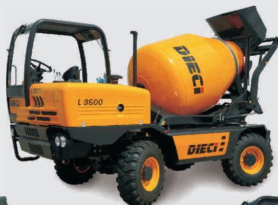
L 3500 112 hp capacité 3,5 m 3 rendement 2,50 m 3
