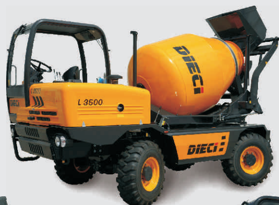
L 3500 112 hp capacidad 3,5 m 3 rendimiento 2,50 m 3
